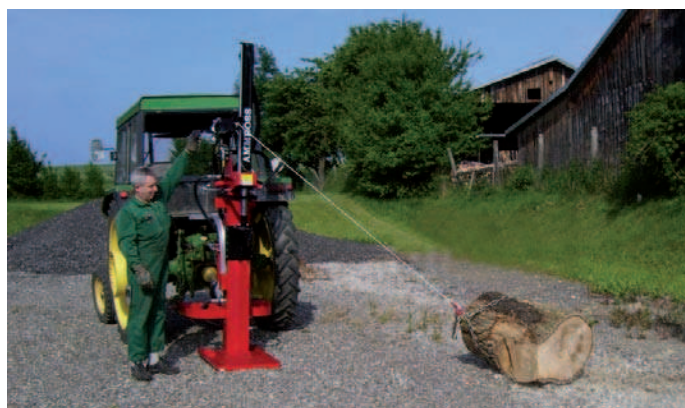
Abb.: Aufbauseilwinde im Einsatz
