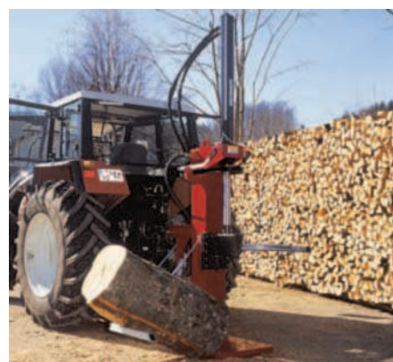
Abb.: Mit mechanischem Stammheber, der zugleich auch als Ablagebügel genutzt werden kann.
