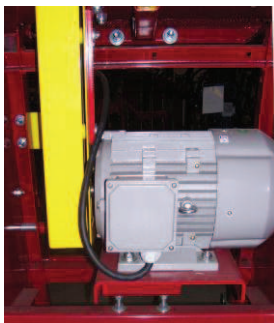
Keilriemenantrieb und Spezial-Kreissägenmotor
